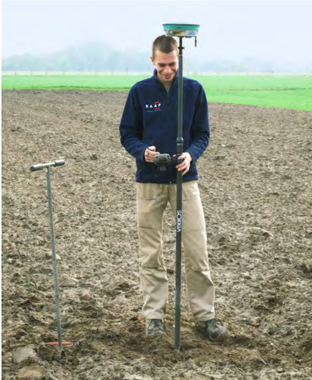
Figuur 66. Het inmeten van een boring met een GPS.
